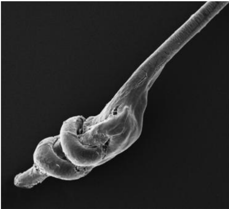
Imagen 7: foto microscópica de una fibra de poliamida extraída
